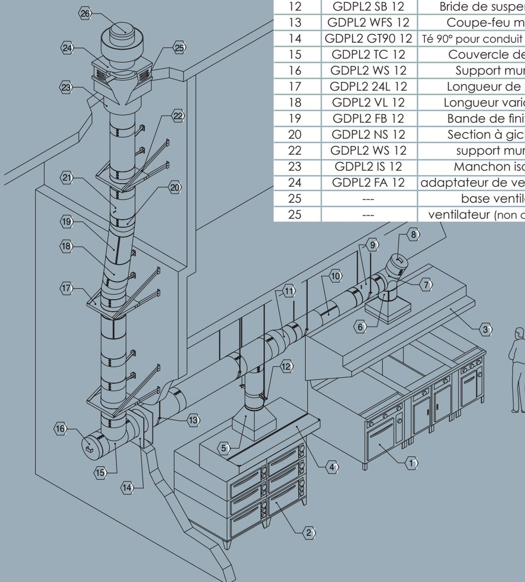
Systeme d'évacuation pour ventilateur à refoulement vertical
